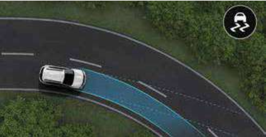
ESP Es un sistema de control electrónico que le permite corregir la trayectoria de un automóvil para evitar que se salga de la carretera. Conduce con seguridad, en todo momento.
